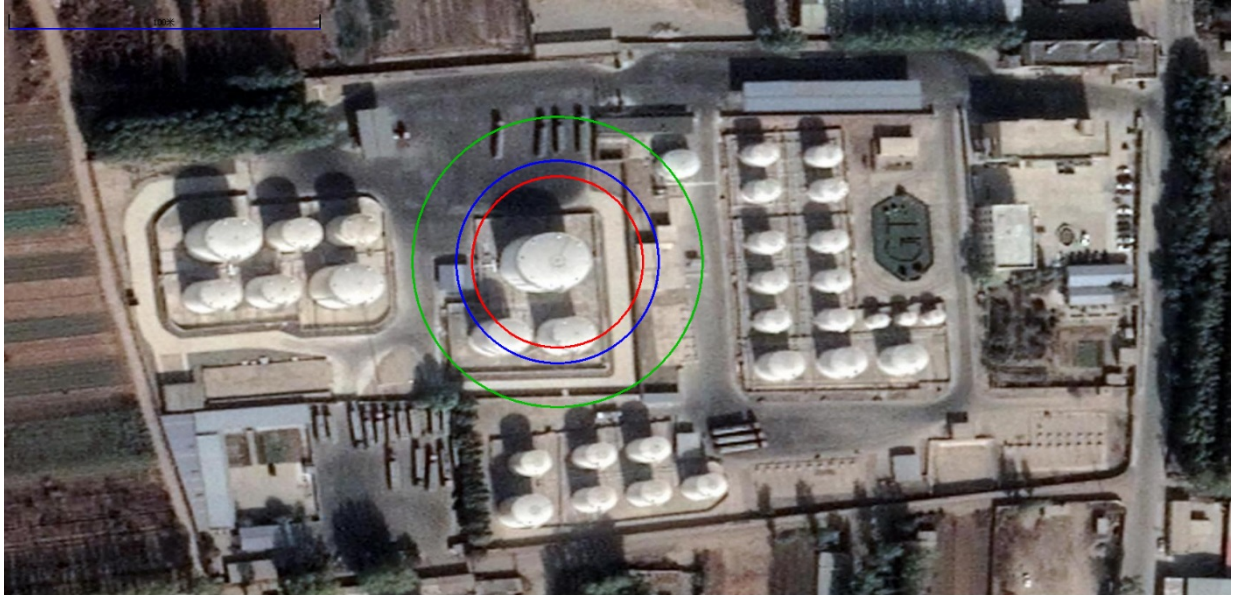
4000m 3 汽油储罐（V601）池火后果模拟图（红线为死亡半径、蓝线为重伤半径、绿线为轻伤半径）
