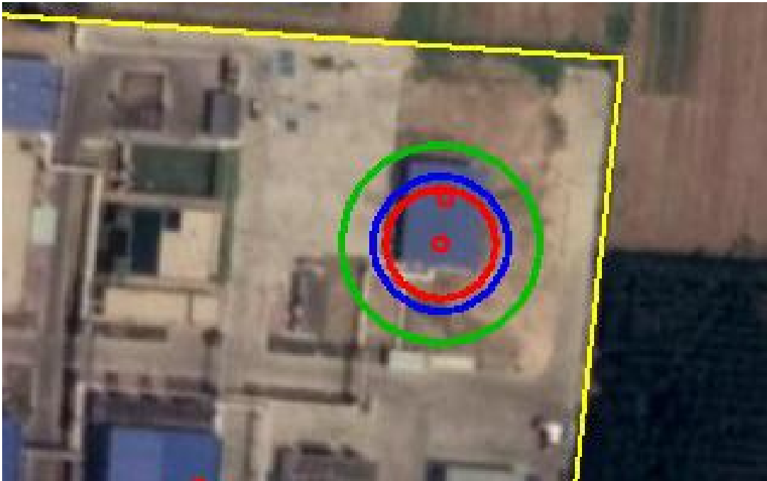
环氧丙烷储罐池火后果模拟图（红线为死亡半径、蓝线为重伤半径、绿线为轻伤半径）
